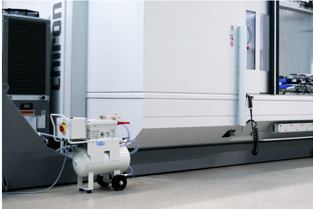
Вакуумная установка VAGG для создания вакуума на обрабатывающем центре с ЧПУ
